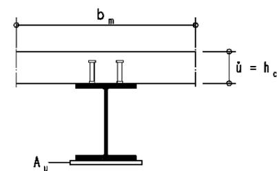
Die Blechabmessungen für die Untergurtverstärkung  $A_u$  kann beliebig gewählt werden (z.B.:  $A_u = 120 \text{ cm}^2 = \text{BL } 30/400 \text{ mm}$ ).
