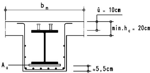
Die Zeilen mit einer Betonüberdeckung  $\bar{u} = 12 \text{ cm}$  bis  $\bar{u} = 25 \text{ cm}$  gelten für Verbundträger mit einer auf dem Oberflansch aufliegenden Betonplatte und einer Mindestplattendicke von  $d = \bar{u}$ .
