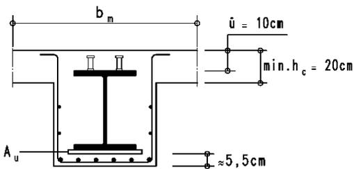
Die Zeilen mit einer Betonüberdeckung  $\bar{u} = 12 \text{ cm}$  bis  $\bar{u} = 25 \text{ cm}$  gelten für Verbundträger mit einer auf dem Oberflansch aufliegenden Betonplatte und einer Mindestplattendicke von  $d = \bar{u}$ .
