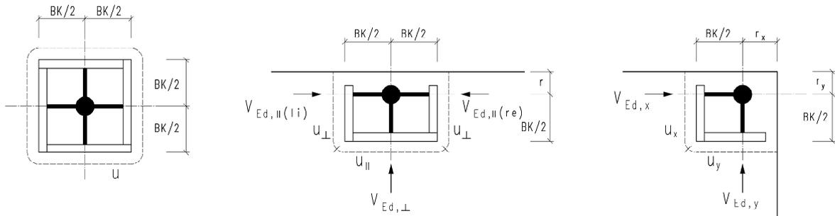
Die Tabellen gelten für gleichmässig belastete Flachdecken aus Beton C20/25 bis C55/67, mit Plattenstärken von 20,0 cm bis 60,0 cm und Längsbewehrungsgraden  $\rho_l$  von 0,5% bis 1,75% bei Innenpilzen bzw. bis 1,5% bei Rand- und Eckpilzen. Bei Flachdecken ist die Europilz®-Unterkante grundsätzlich 2,0 cm über Schalung.
